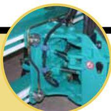
Bloccaggio idraulico della traslazione del braccio sul telaio
