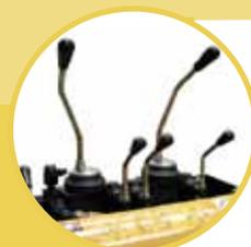
Distributore componibile a cloche che permette movimenti più fini e calibrati (per modelli E21 e E24)
