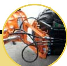
Sollevatore idraulico a parallelogramma
