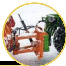
Sistema flottante con parallelogramma meccanico a molle
