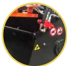
Kit di apertura griglia di protezione manuale composto da maniglia con gancio, molle di sostegno a gas e interblocco idraulico di sicurezza
