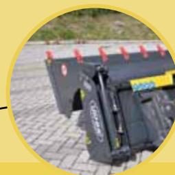
2 cilindri idraulici a doppio effetto
